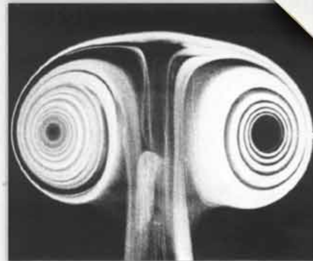
Фото, демонстрирующее принципиально новый высокоэффективный способ тушения пожаров газонефтяных фонтанов, возникающих при авариях на скважинах. Тушение пожара по этому способу осуществляется путем импульсного воздействия на факел воздушным вихревым кольцом, заполненным распыленным огнетушащим порошком
